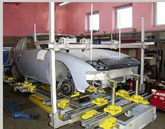
Auf der Karosserierichtbank von Spanesi können Pkw, leichte Lkw und Transporter mit Richtwinkelsätze für alle Fabrikate wieder in Länge und Form gezogen werden.
