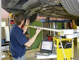
Modernste Technologie kommt zum Einsatz bei der Karosserievermessung mit Spanesitouch-Diagnose.
