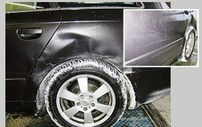
Ist das Karosseriekleid beschädigt, muss es nicht gleich erneuert werden, sondern kann von uns mit modernster Auszieh-technik wieder instand gesetzt werden.
